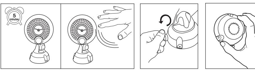
7. Testez le détecteur de mouvement dans un placard ou une salle de bains sombre. Laissez la lampe dans l'obscurité de la pièce pendant 5 minutes. Lorsque vous retournez dans la pièce, la lampe doit s'activer avec le mouvement.
