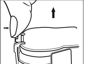
1. Rimuovere la parte anteriore della lampada ruotandola in senso antiorario come mostrato sopra.
