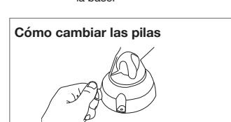
Al cambiar las pilas, retire el vástago de la lámpara y, para ello, afloje el tornillo de mariposa.
