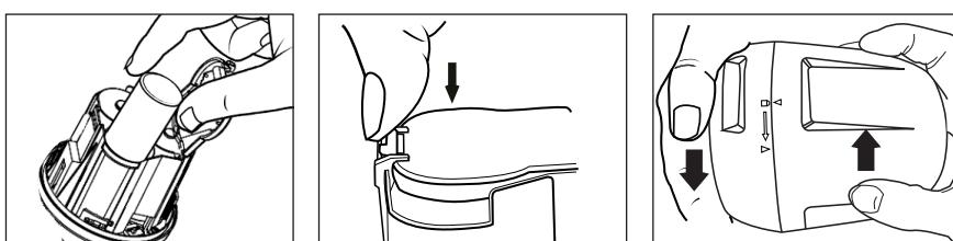
4. Insérez 3 piles de type D en respectant les polarités. Assurez-vous que leurs extrémités plates sont en contact avec les ressorts.
