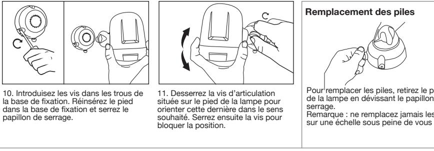
10. Introduizez las vis dans los agujeros de la base de fijación. Vuelva a introducir el pie en la base de fijación y apriete el tornillo de sujeción.
