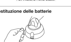
Quando si sostituiscono le batterie, rimuovere il gambo della lampada svitando la vite a testa zigrinata.
