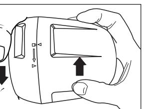
4. Coloque 3 pilas de células D con la polaridad correcta. Asegúrese de que los extremos lisos de las pilas queden en contra de los resortes.
