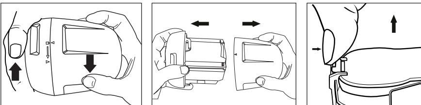
1. Retirez la façade de la lampe en la faisant tourner dans le sens inverse des aiguilles d'une montre comme illustré ci-dessus.
